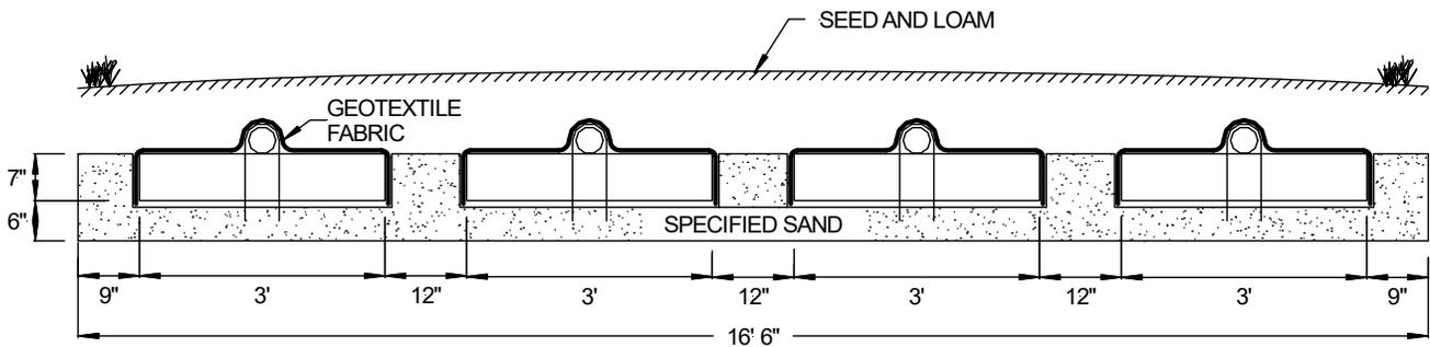
FIGURE 11: PLAN VIEW – STEP DOWN BED – PARALLEL DISTRIBUTION
