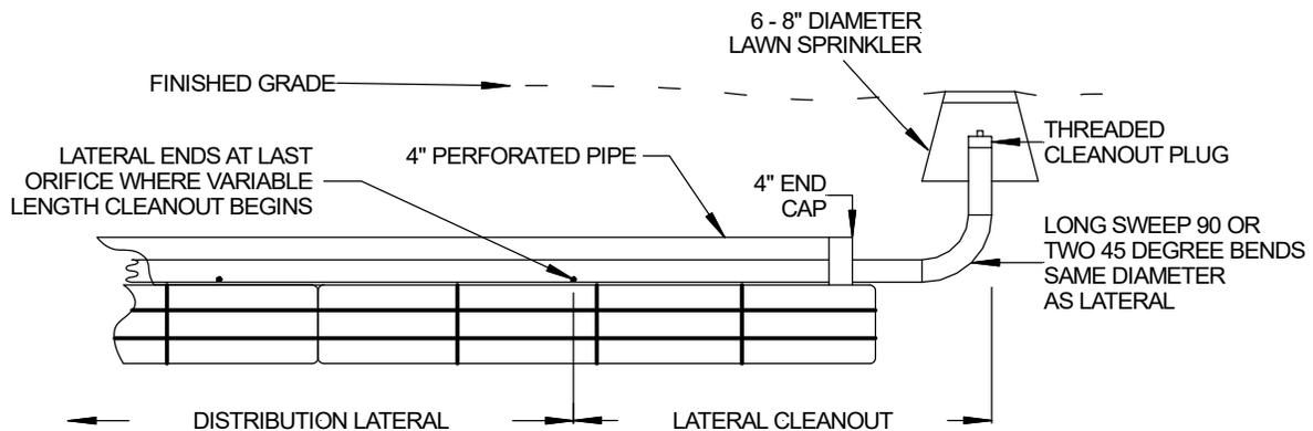
FIGURE 17: CONTOURED TRENCH PRESSURE DISTRIBUTION
